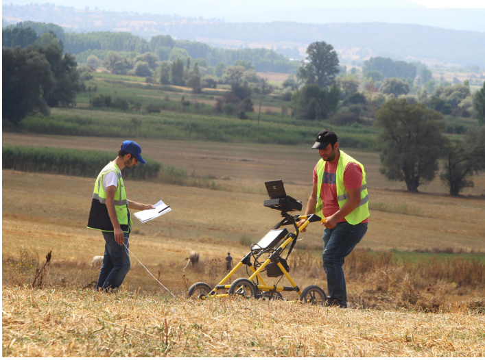
Şekil 5. Yer radarı çalışmaları.
