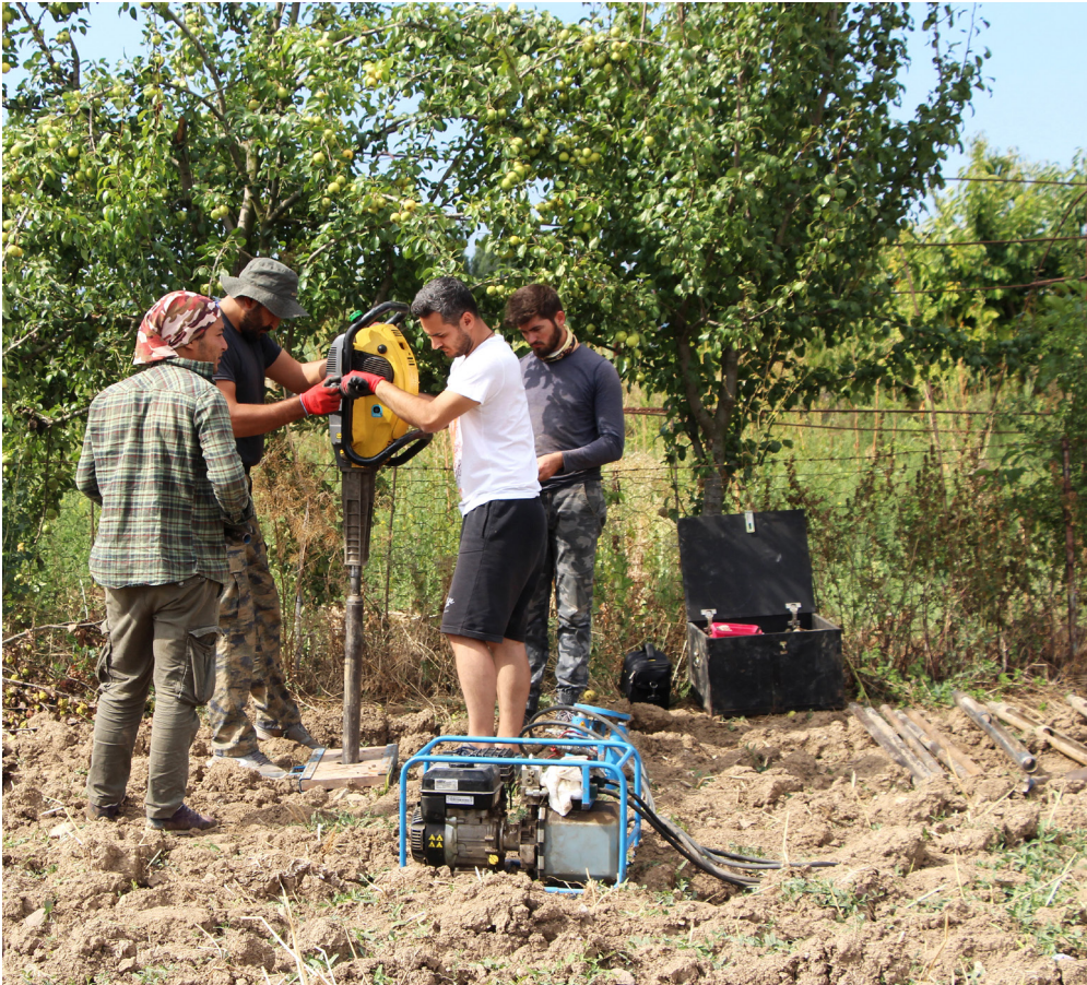
Şekil 4. Jeoarkeolojik delgi sondaj çalışmaları.
