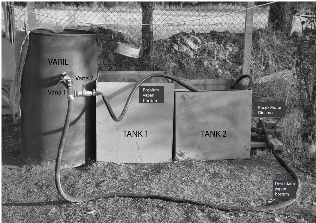
Şekil 1. Aşıklı Höyük suda yüzdürme düzeneği, büyük makine (Fotoğraf: Müge Ergun, Aşıklı Höyük Araştırma Projesi Arşivi).
